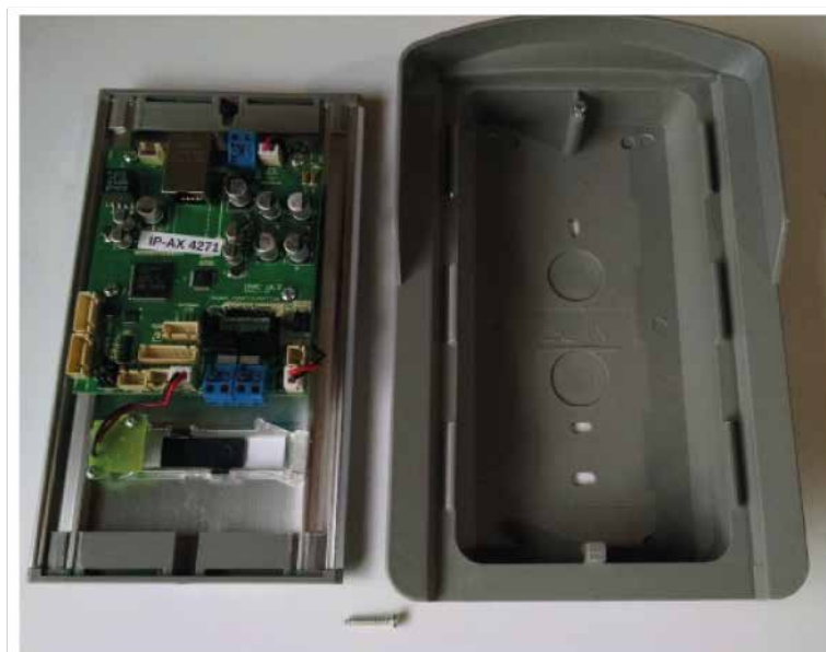
Figura 8 – Vista interna IP Access
